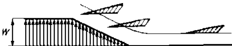
Рис. 121. Изменение вертикальной скорости по ширине восходящего потока
