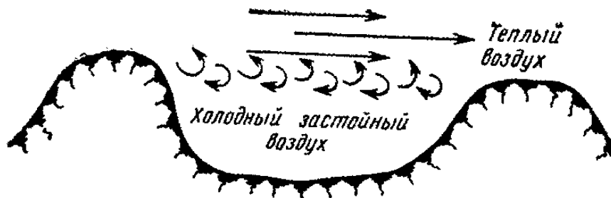
Рис. 136. Сдвиг ветра над долиной при движении теплого воздуха над застойной зоной холодного воздуха
