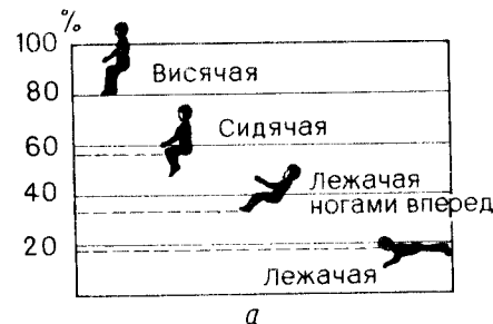
Рис. 14. Пути снижения лобового сопротивления дельтапланериста:
