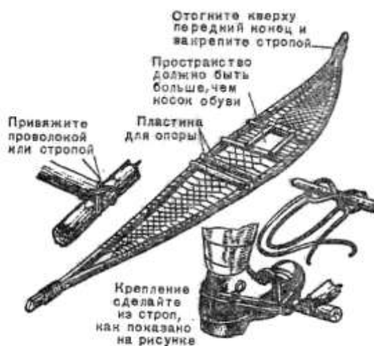
Рис. 33. Изготовление лыж-снегоступов из подручных средств
