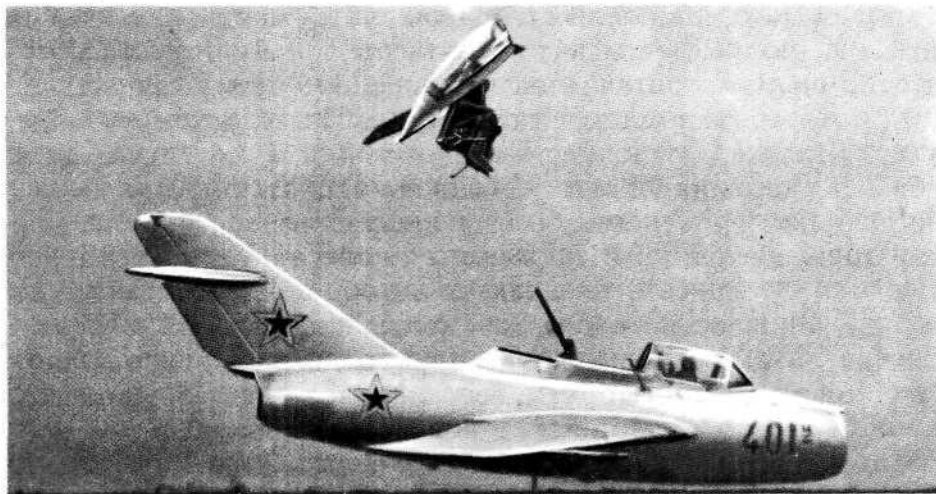
Катапультное сиденье современного самолета позволяет спасти жизнь летчика, даже если высота полета равняется... нулю.
